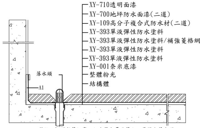
備註：1. 預留管切齊，防水層包覆至管內，再固定落水頭。
