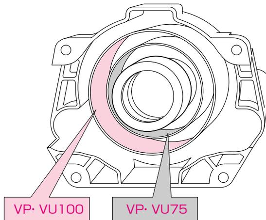
※請按圖示方向安裝排污套管（標籤面朝向）
