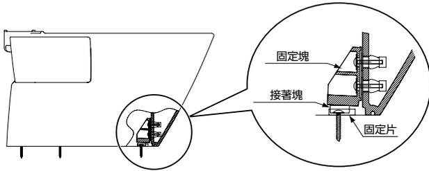
※接著塊被壓緊後，為了調整便器的位置，可左右移動數mm。
