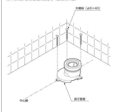
%木螺絲鎖入地板前,若先鑽約 $\phi$ 3預留孔,以便於施工作業。
