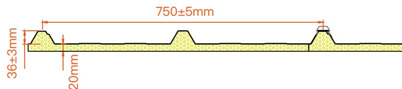
雙層鋼板 (PU 發泡 + 底層鋼板)
